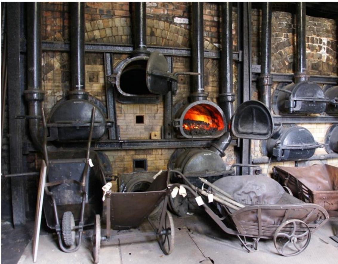
**Fig.63 b-** Vista das retortas para a fabricação de gás de iluminação. Abaixo delas as fornalhas que as esquentavam a ponto de fazê-las liberar os gases das pedras de hulha nelas contidas. Museu do Gás, de Biggar, em South Lanarkshire, na Escócia, Reino Unido. Foto de Otter, 2010.
