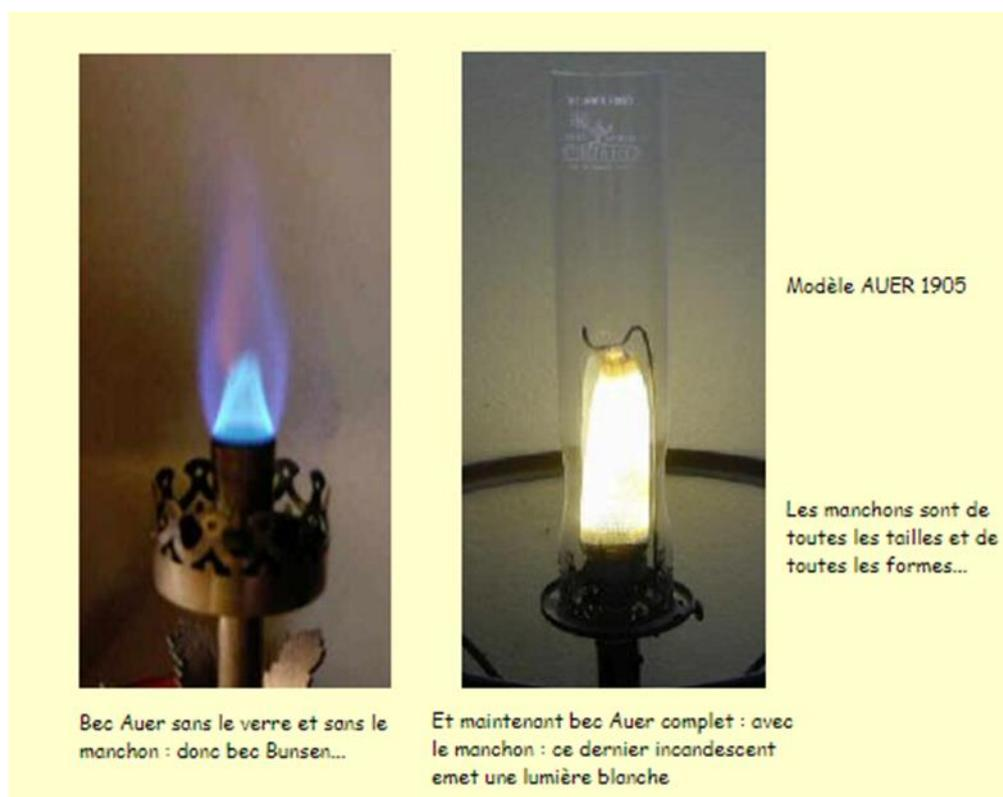
Fig.76c– Bico modelo AUER 1905: à esquerda, um bico de Bunsen, com sua característica chama azul, sem quase nenhum poder iluminante; à direita, com manga de vidro perfurada na base e camisa de incandescência, cuja função era emitir uma luz branca e fixa, de 41 velas. Imagem extraída de *La Maitrise de l'Eclairage*.
