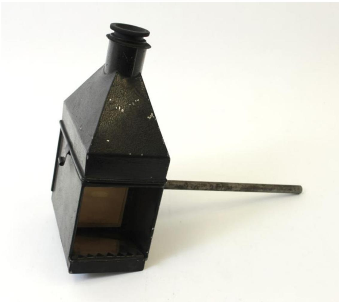
**Fig.74b- Fotômetro de Bunsen. Coleção de instrumentos científicos da Universidade de Toronto, Canadá. Data desconhecida (segunda metade do século XIX?).**
